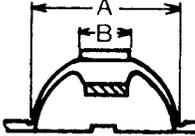
$A \geq B + 2.0\text{mm}$ |                                                                                     | —                                                                                   |
